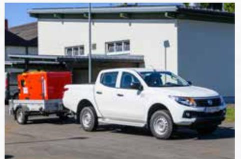
So wie der Wasserverband ist auch der Abwasserverband und damit die Kläranlage mit Notstrom versorgt und funktioniert bei einem Stromausfall. Der Abwasserverband kann seine Pumpstationen mit einem mobilen Notstromaggregat betreiben.
